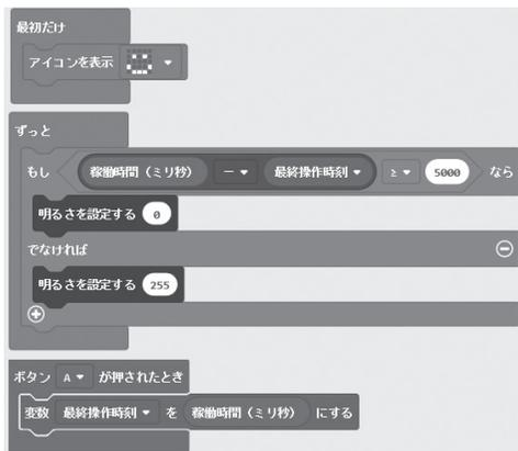
図16 一定時間操作がなければ消灯するプログラミング例
