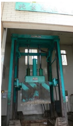
図 4-4 中間ステーションのゴミ圧縮装置
